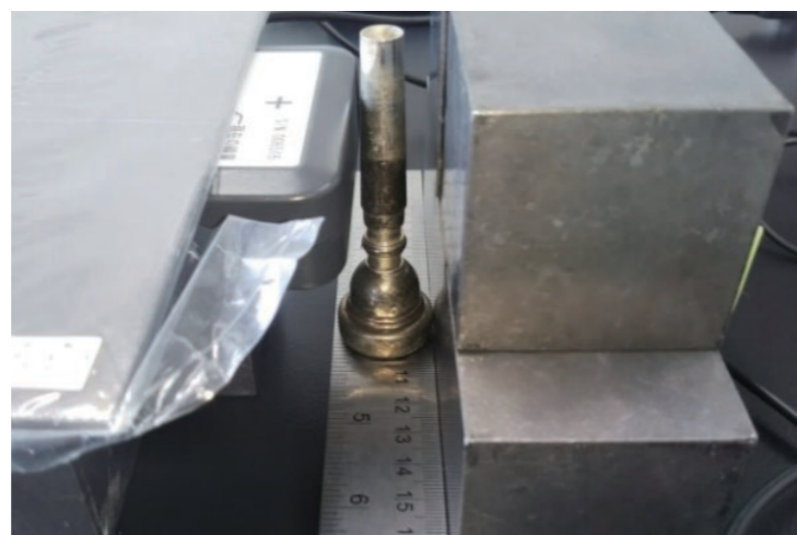
図4 線源_鋼材_検出器の配置(側面)
