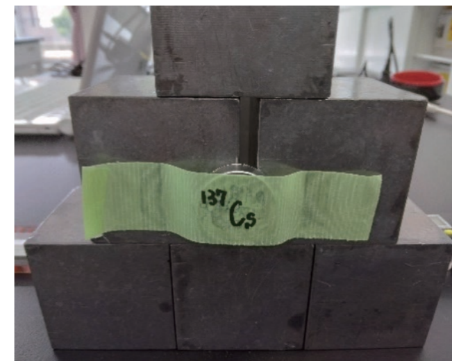
図5 線源_鋼材_検出器の配置(背面:線源側)
