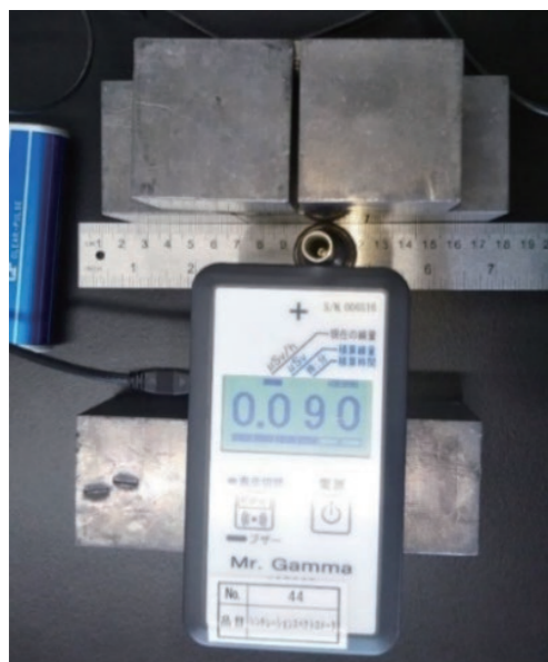
図3 線源_鋼材_検出器の配置(俯瞰)
